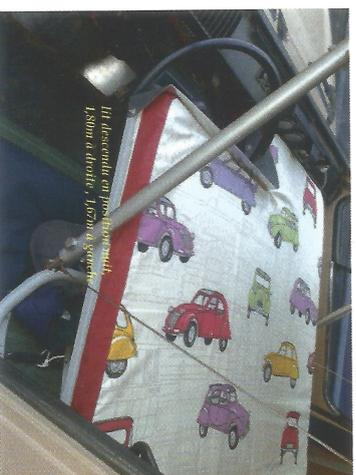
Ein bewegliches Gestänge ist auf der Höhe der inneren Sonnenblenden angebracht. Über 4 Seile und einen kleinen Elektromotor mit Rolle von einem elektrischen Fensterheber kann die Bettkonstruktion dann nach unten gefahren
